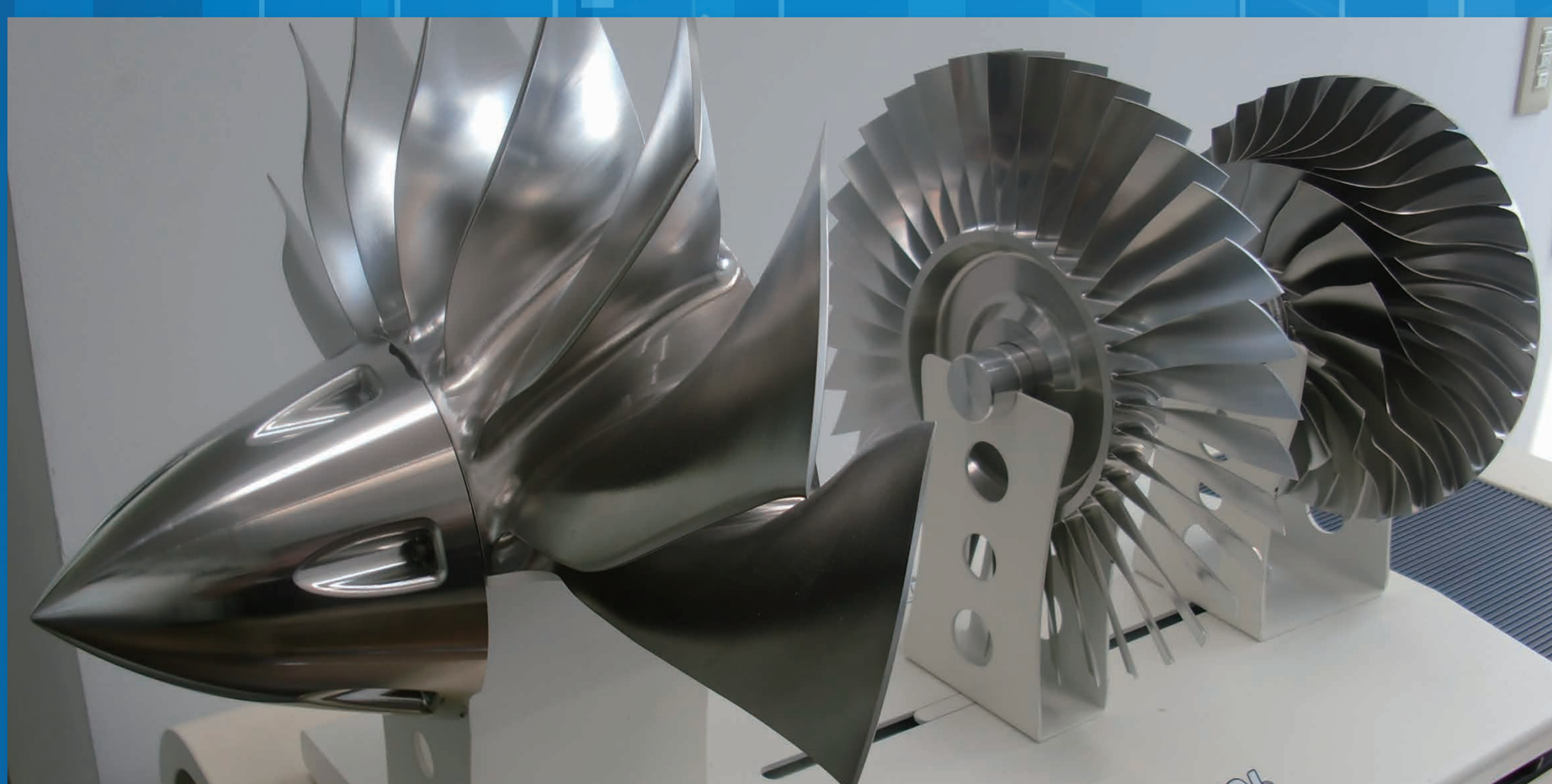
小型ジェット機エンジンカットモデル Cut model of a small jet engine
